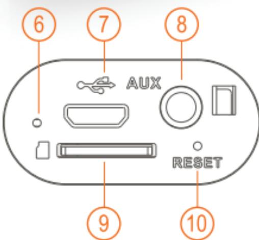
1. Перед первым включением полностью зарядите встроенный аккумулятор. Вставьте microUSB кабель в разъем 7 и подключите к USB порту компьютера или зарядного устройства. Параметры входного напряжения не должны превышать DC 5V 2A.
